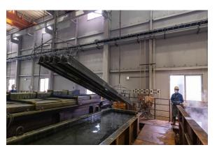
基本的に両端を吊り、適切な傾斜角度を保持する必要がある ため、製品両端に吊り箇所が必要です。吊り孔・吊りピース・ 吊りナットの寸法は、製品の重量や形状に応じて変化します。
