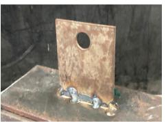
重量物で吊り孔にボルト孔を利用した場合、そのボルト孔が変形する 可能性があります。吊りピース取付について不明な点はご相談ください。
