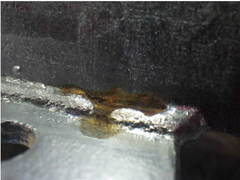
貼り合わせ面にめっき工程の処理液が入る、あるいは雨水などの水分が入り込むことで酸シミや錆汁が表面に流れ出る場合があります。
