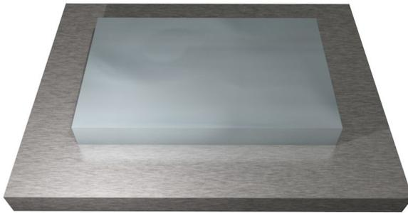
全周溶接を行う場合、貼り合わせ部の面積400㎡ごとに栓溶接を1箇所施して下さい。
